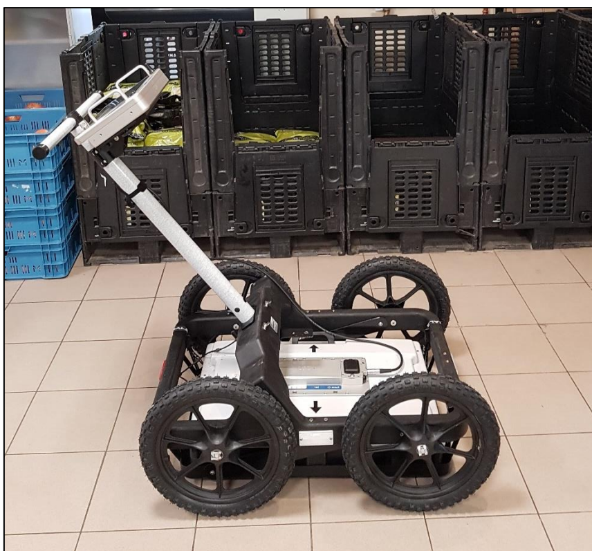
Figuur 3: Foto van de gebruikte GPR-opstelling
