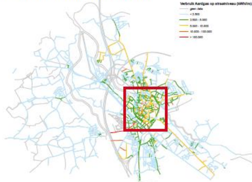
Warmtekaart 2: Lineaire warmtevraag (gebaseerd op open data van Fluvius, 2017). Vanaf 2,5 MWh per m zijn er kansen voor warmtenetten.
