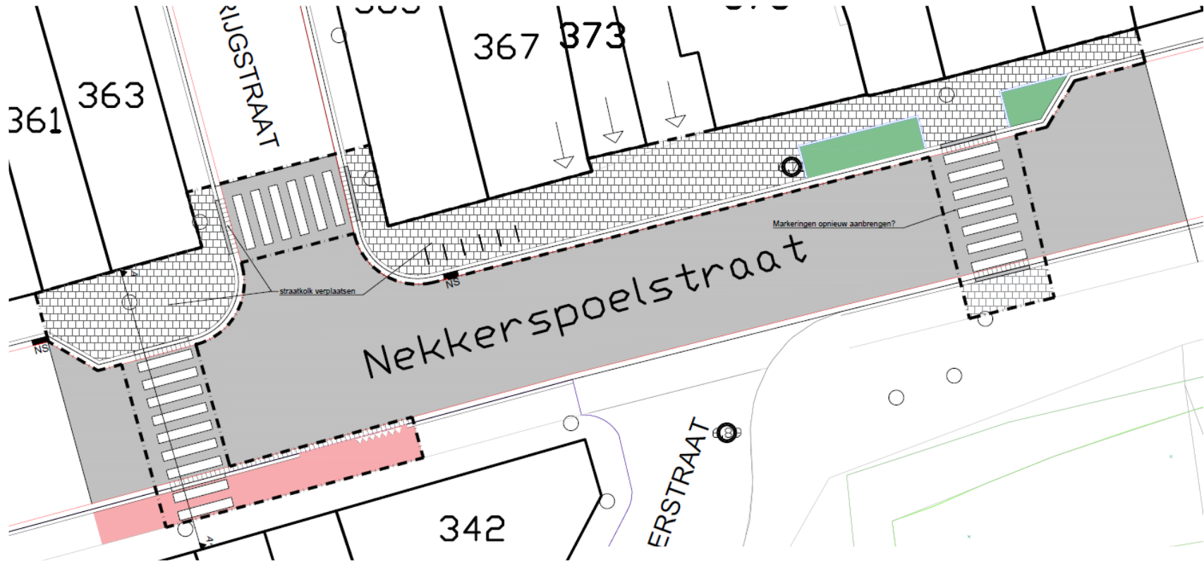
AA' typedwarsprofiel : oversteekplaats
