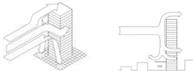
Figuur 373: Valeffect bij hoogbouw: Hoge gebouwen met een rechtlijnige plattegrond beïnvloeden vaak de wind op straatniveau negatief doordat de hoge winden langs het oppervlak van de constructie naar beneden kunnen stromen. Zodra de wind de grond bereikt, wordt deze versneld rond de maaiveldhoeken. Rechts: voorbeeld effect luifel.
