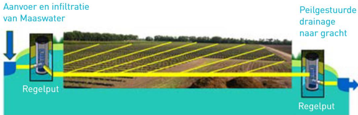
Figuur 14: Illustratie van het gebruik van een peilgestuurd drainagesysteem voor subirrigatie
