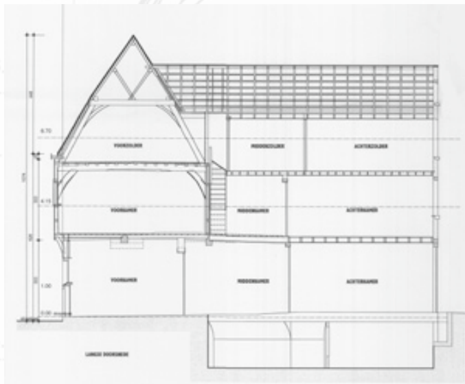
Een langsdoorsnede van het gerestaureerde Hanswijkstraat 52 met de 16de-eeuwse houtbouw (links) en de dwars daarop aansluitende 19de-eeuwse achterbouw (rechts). Deze tekening illustreert goed hoe de verdieping van de houtbouw lichtjes 'uitkraagt' over de straat. Architecten K. Beeck en L. Doms ©
