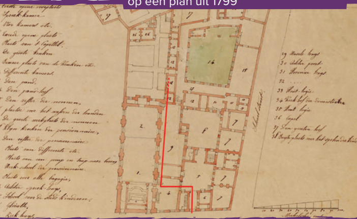
Tracé van de leidingsleuf geprojecteerd op een plan uit 1799
