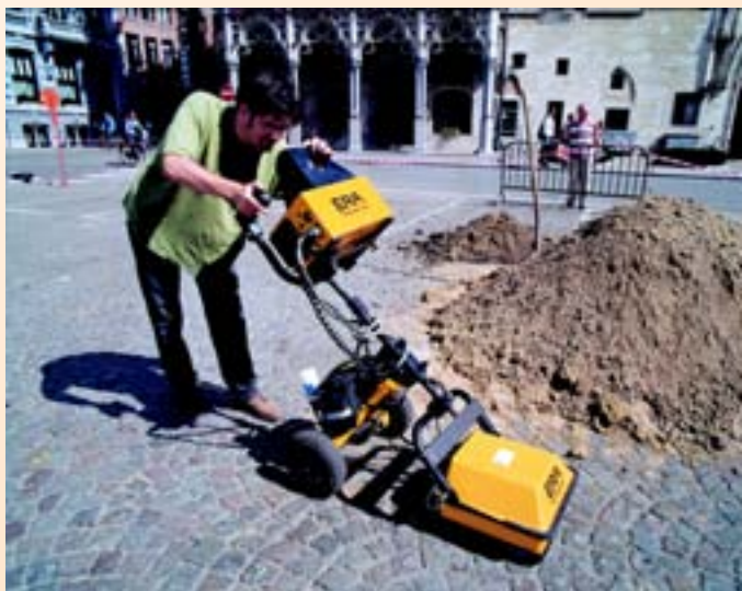
met een grondradar wordt de markt onderzocht op holle ruimten, muurstructuren...
