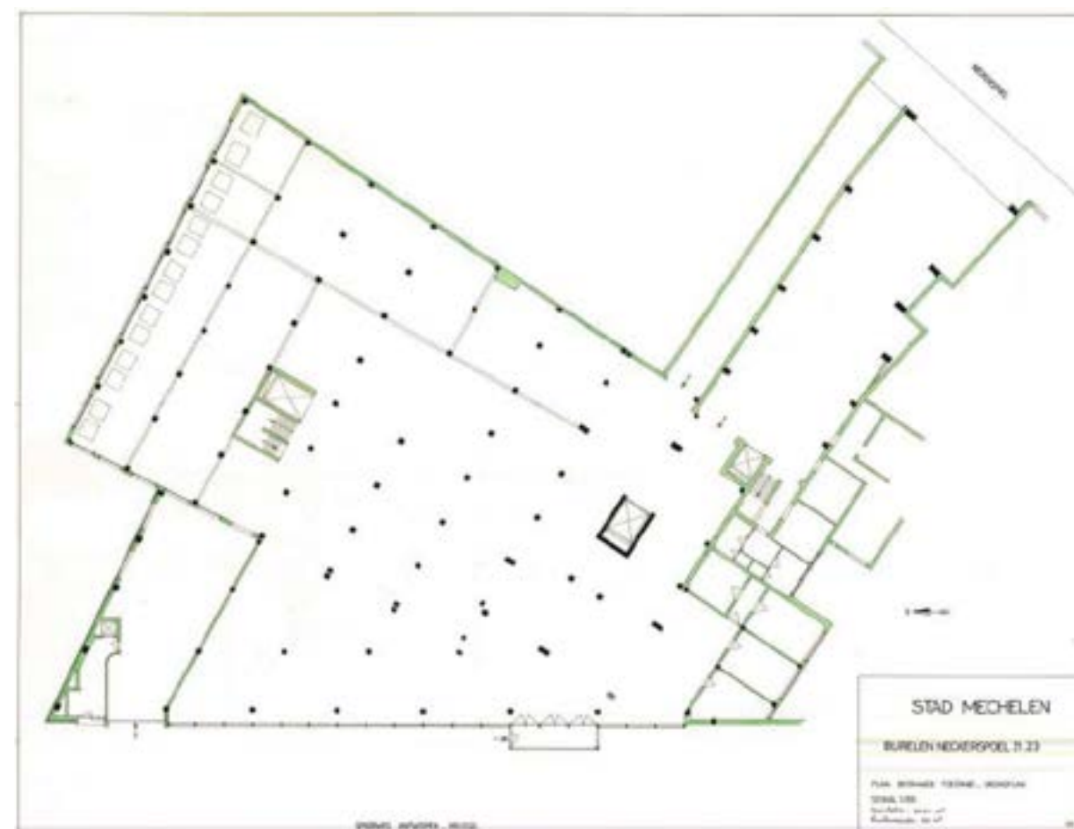
Plan gelijkvloers Novagebouw - toont de ontdubbelde kolommenstructuur
