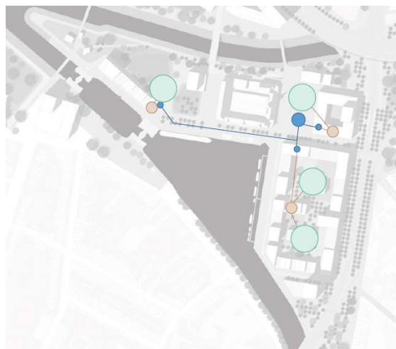
Energienet op Keerdok (blauwe lijnen) zoals uitgevoerd door Aquafin en Noven, met riothermie (grote blauwe cirkel), BEO-velden (groene cirkels) en collectieve bodem/water warmtepompen (rode cirkels)
