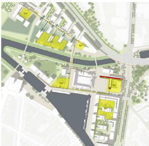
Energienet op Keerdok volgens het concept van Fluvius, met BEO-velden (gele vlakken) en de rioolcollector met warmtewisselaar (rode lijn) (bron: Ingenium)
