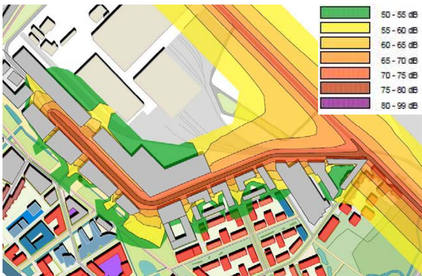
Figuur 376: Geluidscontourenkaart Lden (overdag) wegverkeer Motstraat voor geplande situatie (bron: Rapport screening masterplan Ragheno, Tractebel, 2018)
