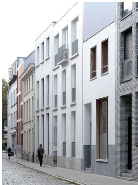
Figuur 243: Referentie plint of gelijkvloerse verdieping solide basis met voldoende hoogte (3.50m tot 4.50m), duidelijke portriek, reliëfrijke gevel, verticale gevelordening ook in geval van grondgebonden woningen
