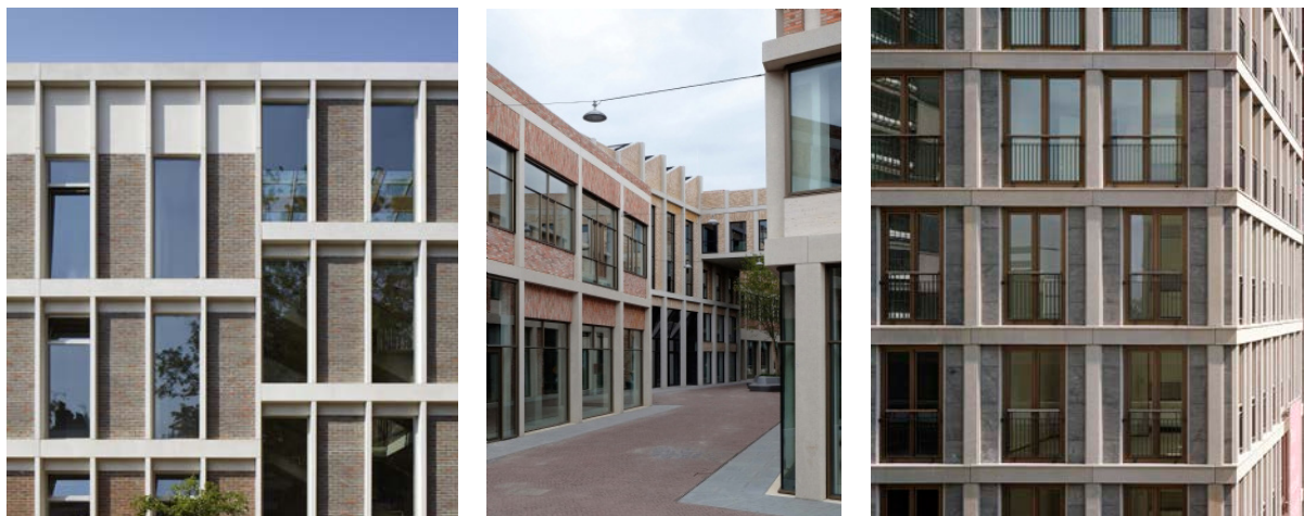
Figuur 245: Verticale gevelordening, evenwichtige verhouding tussen open/gesloten geveldelen, reliëfrijke gevel, o.a. met voldoende dagdiepte
