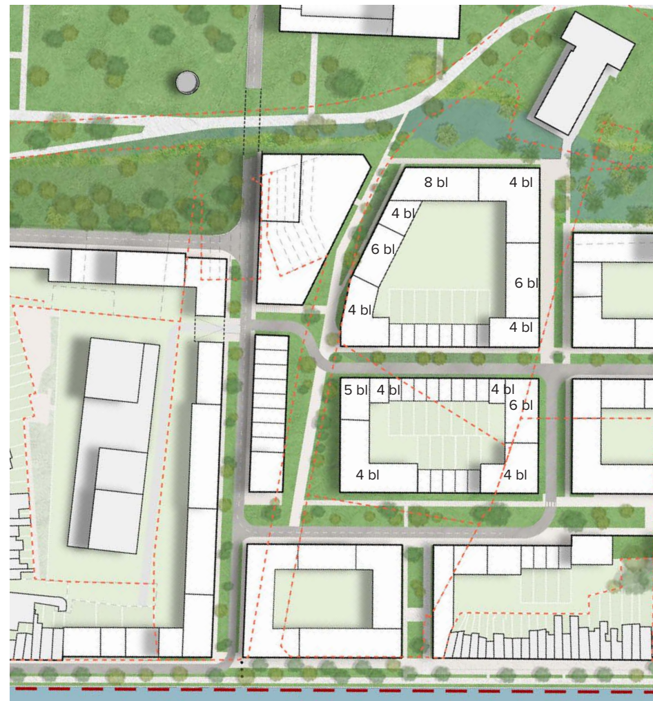
Figuur 300: Onderdeel masterplan omgeving Crescent en De Lijn: toekomstige sloop huidige gebouwen en nieuwe bouwblokkenstructuur, schaal 1:2500
