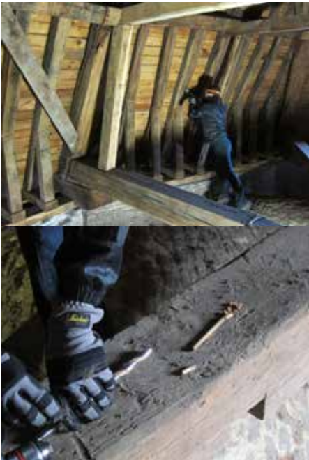
Staalname in het dakgebinte van het koor voor het dendrochronologisch onderzoek.
