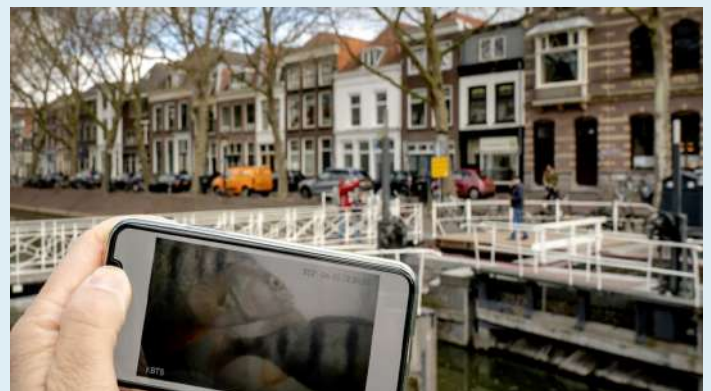
referentie - De Visdeurbel: door middel van een camera kan iedereen kan seintje geven om vis door te laten aan sluis - OAK Consultants
