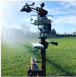
Raindancer Pro met Sektorverstelling om variabel te irrigeren (bron: Mechanisatie Centrum Flakkee)
