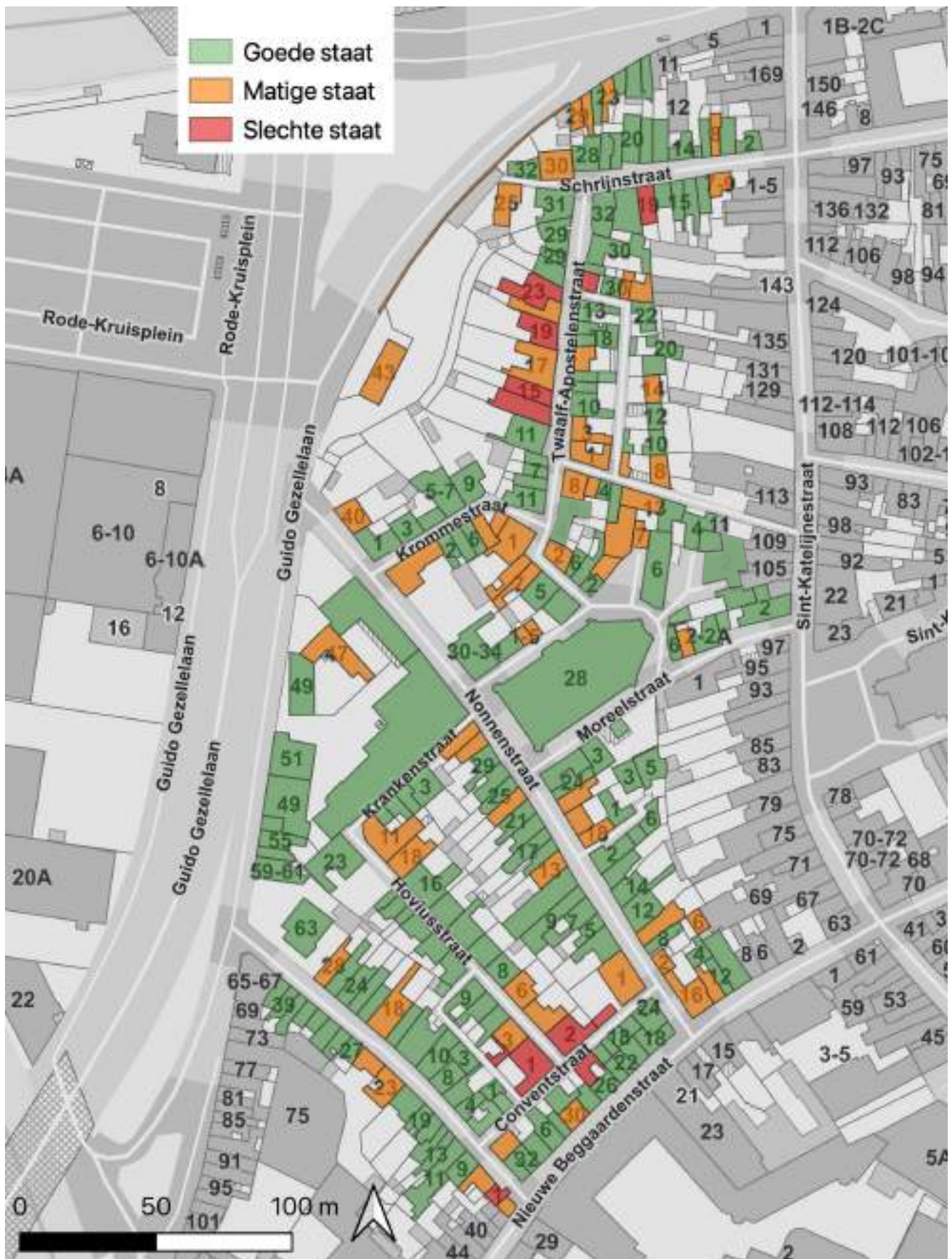
Figuur 17 Categoriatisatie van de bouwfysische toestand van het bouwkundig erfgoed
