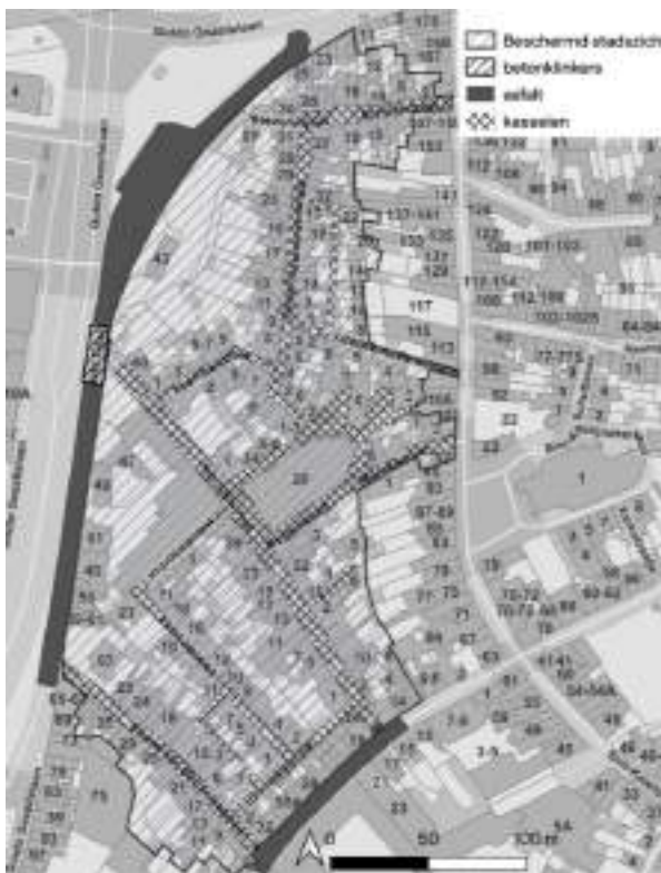
Figuur 19 Overzicht van de huidig verschillende wegdektypes
