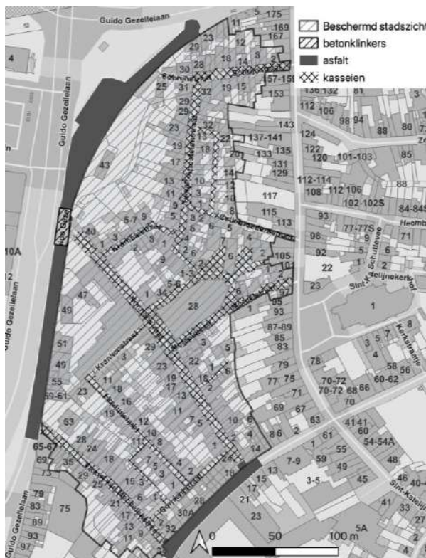
Figuur 19 Overzicht van de huidige verschillende wegdektypes
