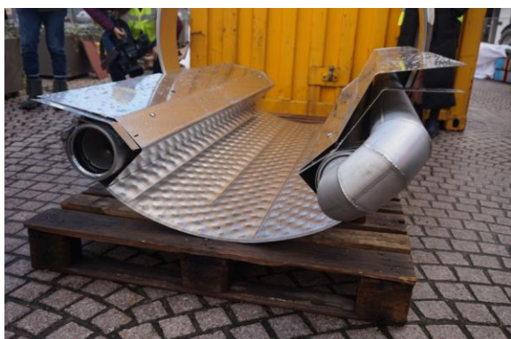
Opstelling van de warmtewisselaar net voor plaatsing in de rioolcollector aan de Winketkaai, Mechelen (© Stad Mechelen)
