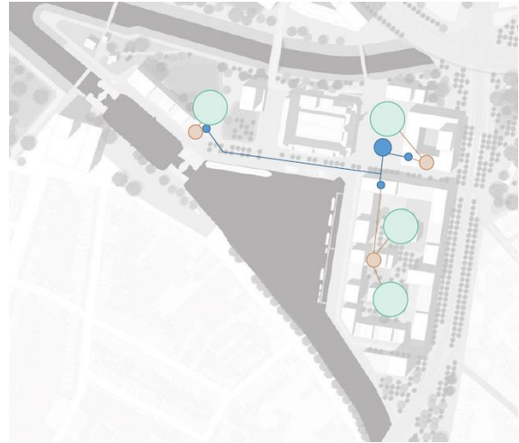
Energienet op Keerdok (blauwe lijnen) volgens het concept van Aquafin en Noven, met riothermie (grote blauwe cirkel), BEO-velden (groene cirkels) en collectieve bodem/water warmtepompen (rode cirkels) (beeld: Noven)
